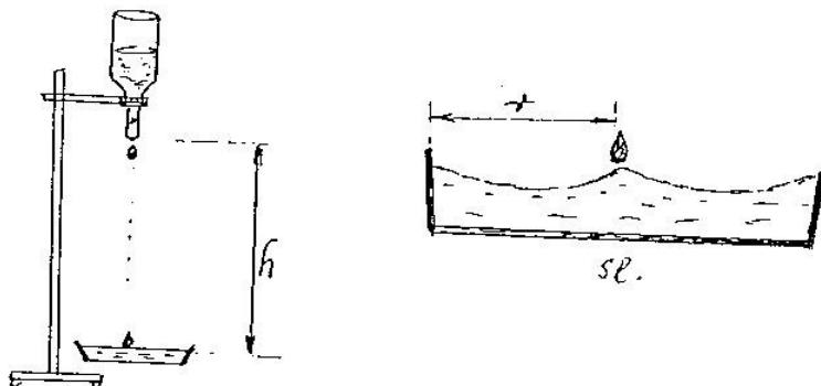
Poremećaj (val pređe put od sredine posude do ruba i nazad do sredine  $s = 2r$  pa je brzina vala  $v = 2r/t$  (promjer  $2r$  izmjeriti mjerom trakom)
