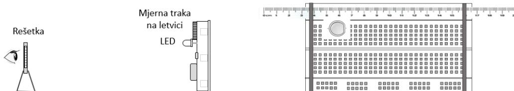
Optičku rešetku (u plastičnom okviru) postavite u veliku spajalicu za papir. Eksperimentalnu pločicu koju ste koristili u prvom dijelu vježbe okrenite okomito. Neka je LED postavljena u gornjem dijelu pločice (na skici nije prikazan električni sklop iz prethodog dijela zadatka, potreban za napajanje diode!). Pričvrstite letvicu s mjernom trakom pomoću gumica, neposredno iznad LED kako je prikazano na slici.
