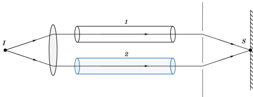
Slika 1: Interferometar za određivanje indeksa loma materijala.
