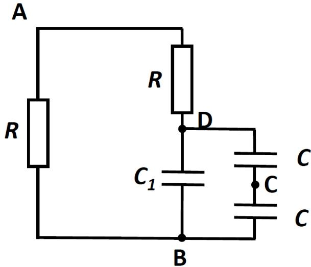
Tri kondenzatora možemo preračunati u jedan efektivni kondenzator po pravilima paralelnog i serijskog zbrajanja kapaciteta: **(2 boda)**
